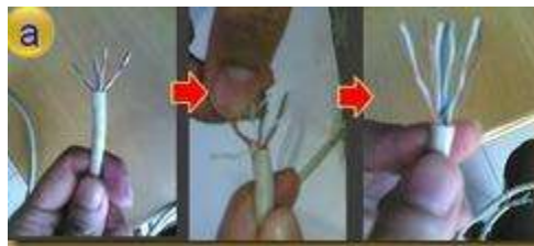
Gambar 3.22: Cara merapikan ujung kabel
