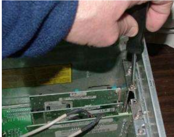
Gambar 3.12: Menguatkan kartu pada slot
