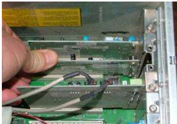
Gambar 3.11: Menguatkan kartu pada slot
