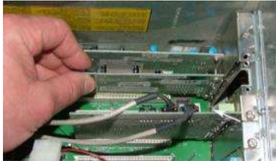
Gambar 3.10: Pemasangan kartu pada slot
